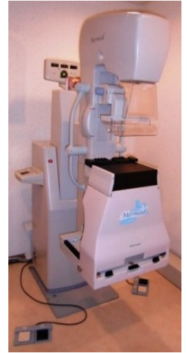
マンモグラフィ撮影装置 コニカミノルタ社製 マーメイドPCM
